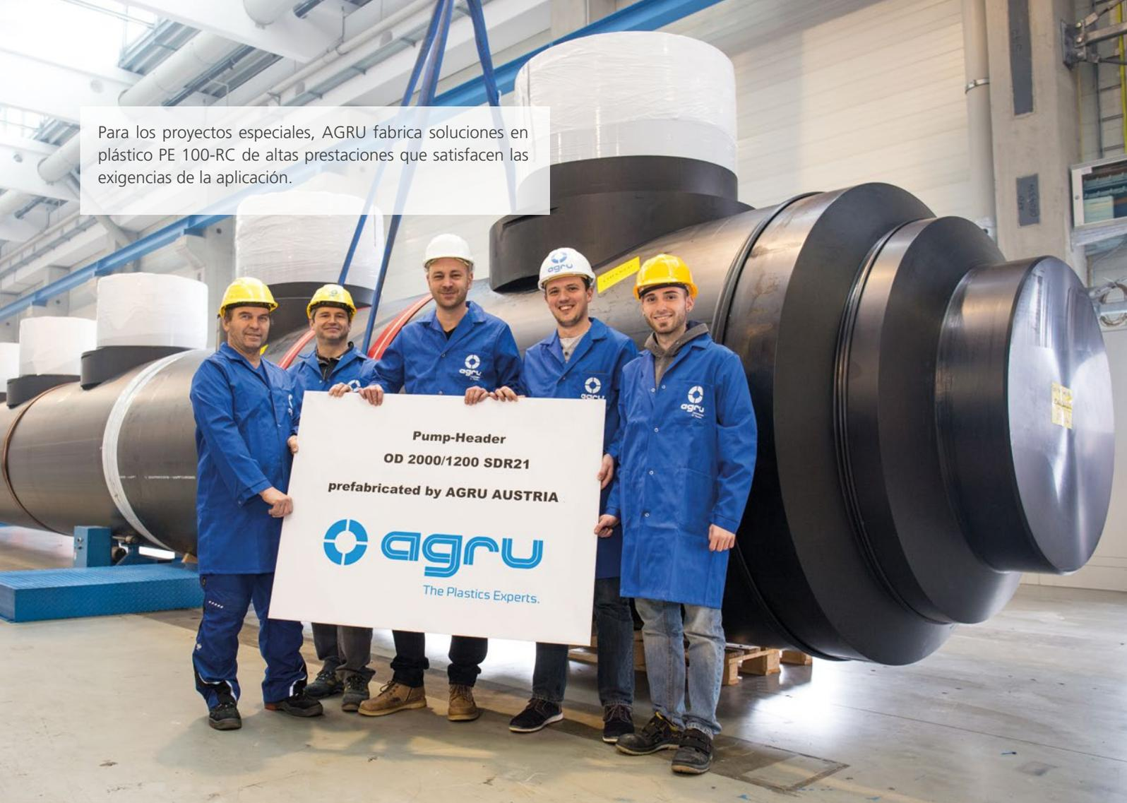
Los accesorios AGRU de PE 100-RC representan actualmente el punto álgido de más de 50 años de trabajo de desarrollo. La fabricación de alta precisión, así como la resistencia total a la presión y a las cargas puntuales, ofrecen nuevas oportunidades para la instalación de tuberías de PE.
