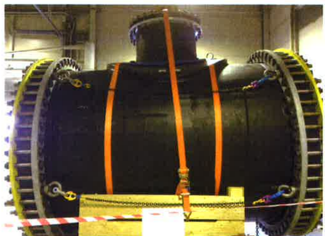
Foto 3 - Test de prueba a escala completa de 2 bars a un saddle de OD1000 sobre un tubo de OD2500
