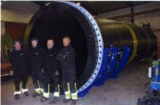
Foto 5 – Valona y brida loca en un tubo OD2500, SDR26
