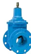
**2015** La válvula Hawle-E1+/Hawle-E1 es el resultado de un consecuente desarrollo de nuestra válvula Elypso probada durante décadas. El soporte de las juntas tóricas está alojado mediante sistema bayoneta en el tapa completamente revestido con epoxi en polvo. Las guías de cuña de POM garantizan un uso duradero libre de desgaste.
