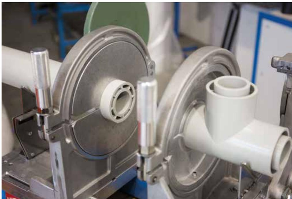
El sistema de tuberías dobles Poly-Flo de AGRUCHEM puede unirse de forma rápida mediante soldadura simultánea.
