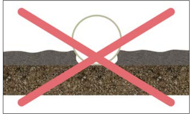
Fig. 14: Relleno de apoyo inadecuado
