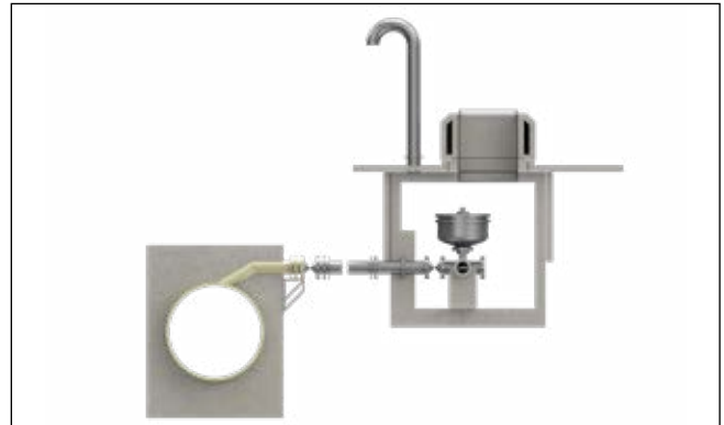
Fig. 84: Método alternativo para alojar una ventosa grande con tubería Amiblu
