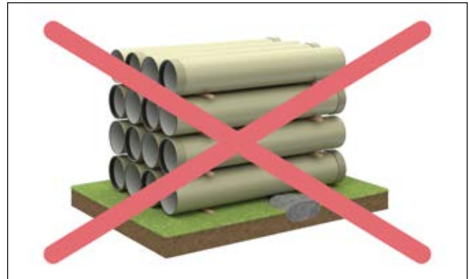
Fig. 8: Las tuberías no deben descansar sobre piedras
