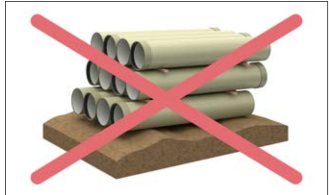
Fig. 9: Las tuberías no deben descansar sobre una superficie irregular
