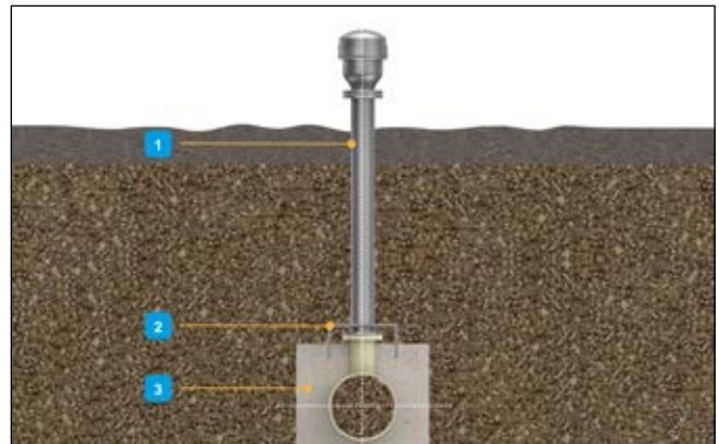
Fig. 82: Bloque de anclaje para grandes profundidades de enterramiento
