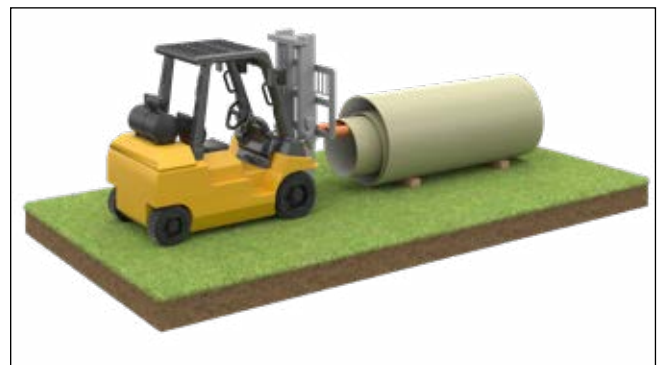
Fig. 5: Desanidado de tuberías con horquillas protegidas
