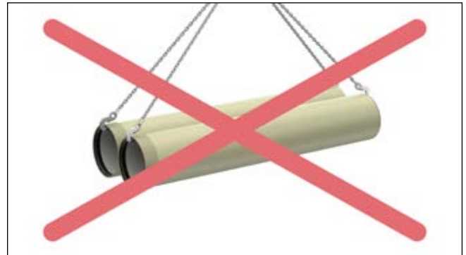
Fig. 3: Los ganchos y cables metálicos no deben entrar en contacto directo con la tubería para su transporte
