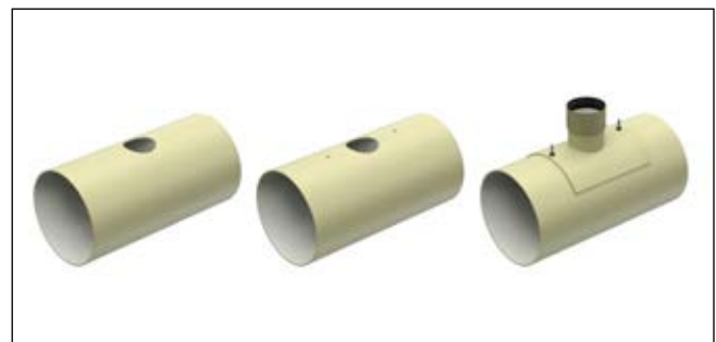
Fig. 69: Montaje de derivaciones atornilladas
