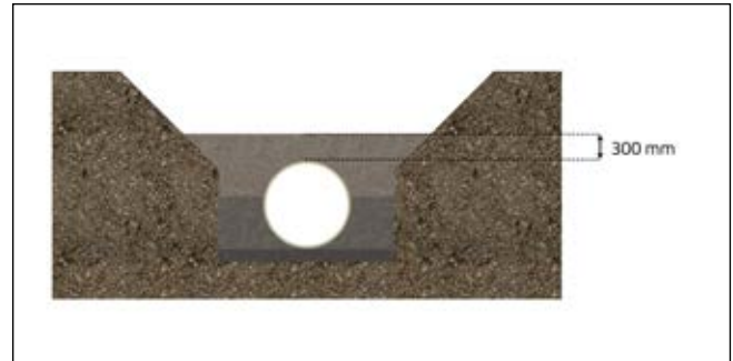
Fig. 73: Excavación de tuberías con exceso de deflexión
