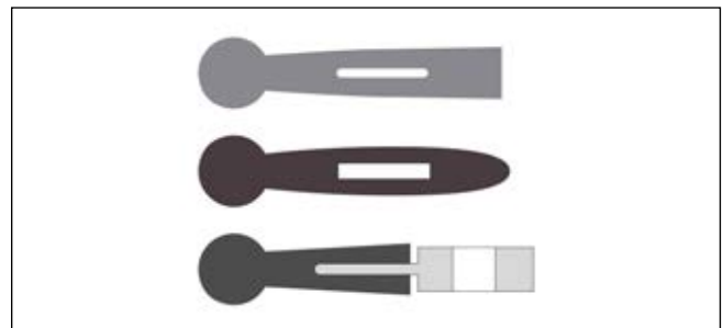
Fig. 41: Secciones transversales de juntas perfiladas habituales
