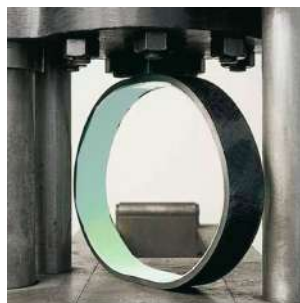
Gracias a su elasticidad, el poliuretano se mantiene intacto frente a una deformación de la tubería.
