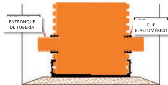
Acabado del fondo del pozo con base estanca (necesario con freático)
