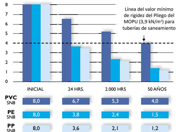
EVOLUCIÓN DE LA RIGIDEZ RCE = (E<sub>c</sub>I)/D<sub>m</sub><sup>3</sup> CON EL TIEMPO SEGÚN LA NORMA DIN 16961
