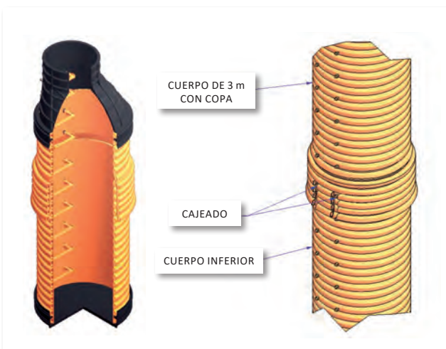
POZOS PROFUNDOS MEDIANTE 2 MÓDULOS
