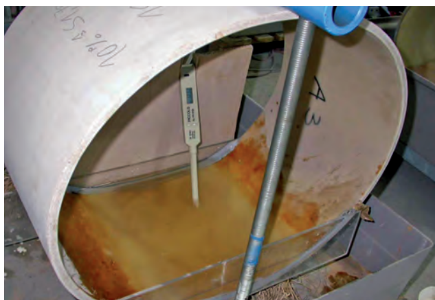
ENSAYO DE RESISTENCIA QUÍMICA.
