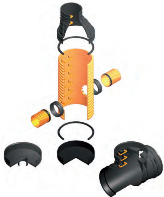
ESQUEMA GENERAL DE COMPONENTES DEL POZO SANECOR® CON LAS DIFERENTES ALTERNATIVAS DE CONEXIÓN AL COLECTOR.
