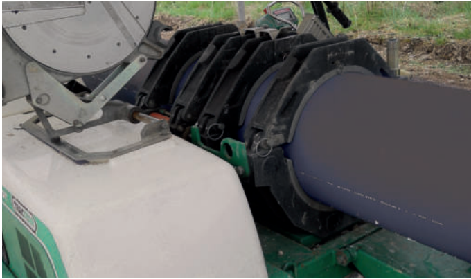
Máquina de fusión a tope antes de comenzar el proceso de fusión
