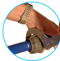
7. Apretar completamente la tuerca libre y marcar la posición de la junta plana en el contador de agua; insertar en profundidad utilizando una llave para el último 1/4 de vuelta.
