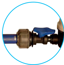
6. Introducir la tubería y verificar la marca: el espacio debe ser inferior a 1 cm.
