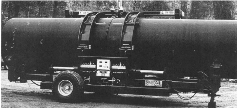
Fig. B.2.2 Máquina soldadora por fusión a tope BW 1600.
