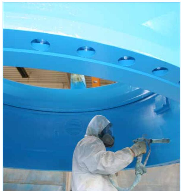
RECUBRIMIENTO EPOXI EN LA PLANTA DE ERHARD EN HEIDENHEIM, ALEMANIA
