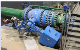
Las válvulas de esfera en aplicaciones hidroeléctricas y de almacenamiento bombeado garantizan el mejor rendimiento hidráulico sin pérdida de carga, así como una protección óptima de las turbinas y las bombas.
