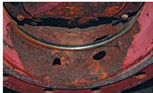
El uso continuo indebido de válvulas de mariposa como válvulas de control puede tener como resultado daños materiales dramáticos, como en esta válvula abierta un 5° durante un año en aguas residuales.
