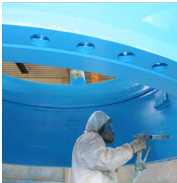
RECUBRIMIENTO EPÓXICO EN LA PLANTA DE ERHARD EN HEIDENHEIM/ALEMANIA
