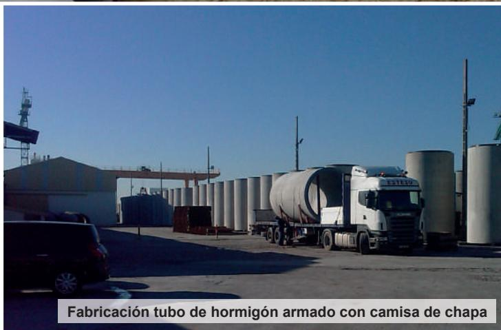
Fabricación tubo de hormigón armado con camisa de chapa
