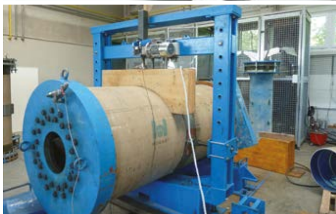
Imágenes, de arriba abajo: prueba de corrosión por alargamiento unitario a tracción, base de diseño hidrostático (HDB), ensayo de flexión a largo plazo y ensayo de la unión.
