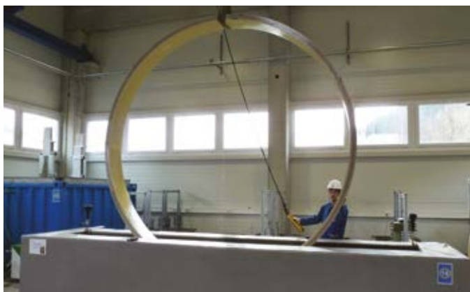
Arriba: prueba de resistencia a la abrasión. Abajo: ensayo de rigidez a largo plazo.
